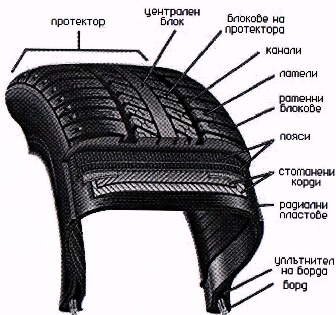
Структура на радиална автомобилна гума
